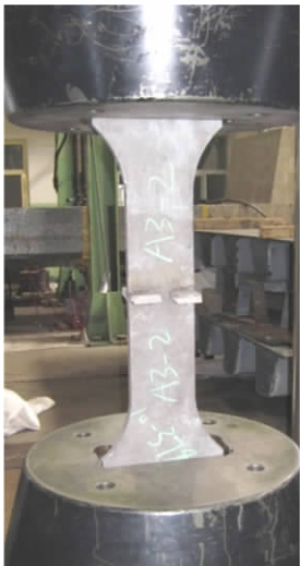
图 2 箱形杆件隔板板厚系数试件
