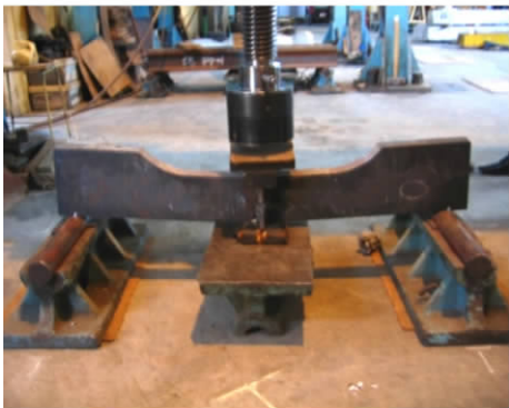
图 1 箱形杆件隔板焊缝弯曲试件
