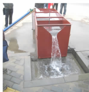
图1 世纪大道站现场抽水试验
