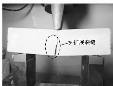
图 10 掺加纤维试件抗折强度试验破坏形态
