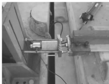
图 2 钢轨纵向阻力试验的加载位置
