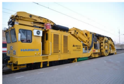
图 1 GO4S-III-CN-SH 型道岔清筛机
