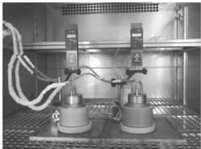
图 1 HL41T 高低温试验箱中的土样
