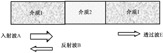
图 4 有夹层时波的传播与反射
